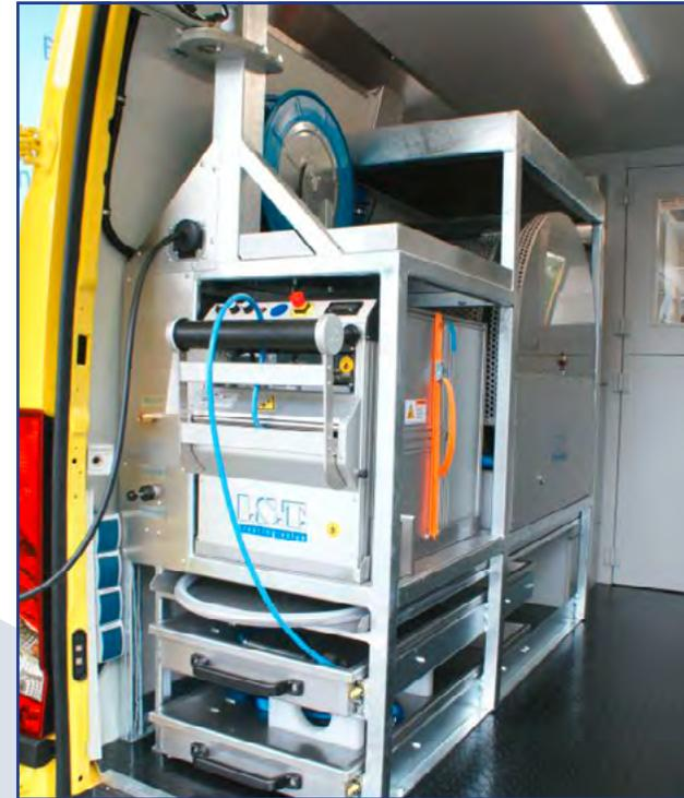
Videoarbeitsplatz, PC 200 mit motorischer Schlauchtrommel
